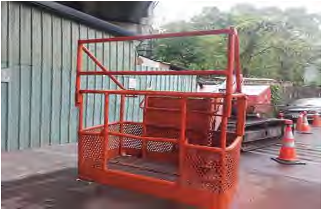
圖 7、高空工作車操作台配置防護設備
