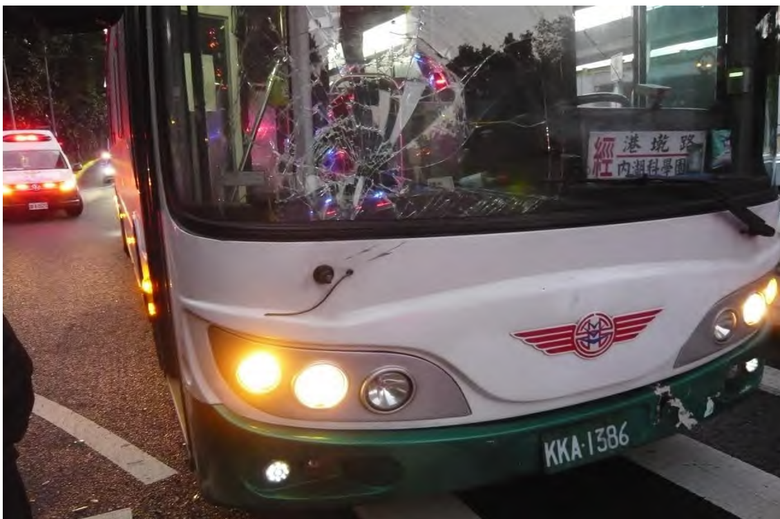
圖 3、因撞擊力大，公車右前擋風玻璃破裂
