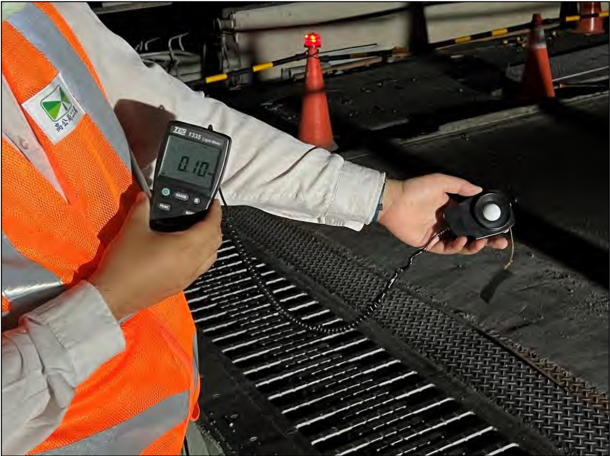
圖 7、夜間照明檢測
