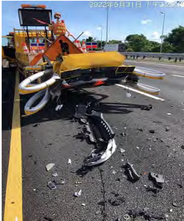
圖 2、事故現場緩撞車情形
