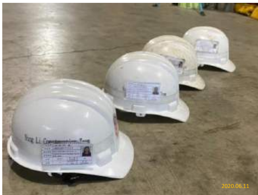
圖 10、安全帽貼控管人員進出
