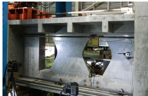
1/2モデルによる梁試験
