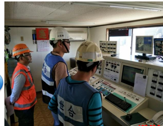
試拌配比確認
