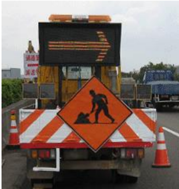
標誌車載式移動式 LED 標誌板相片例
